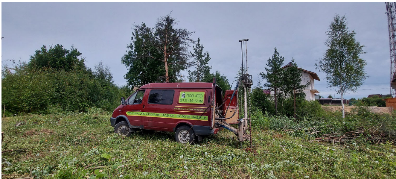
Рисунок 4. Буровая установка «Колибри» на базе автомобиля ГАЗ-27527 «Соболь».
